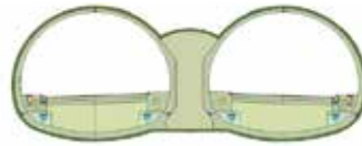
5. 完成管道、水溝、路面工程
