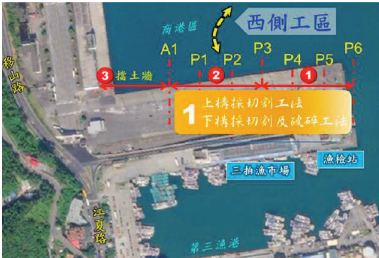
舊南方澳大橋拆除作業配置圖
