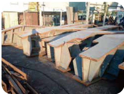
• 間隔梁成品組立
