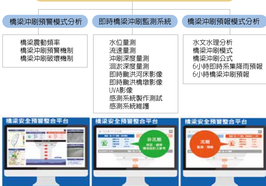
應用高科技監測設備診斷橋梁健康指標及監測計畫
