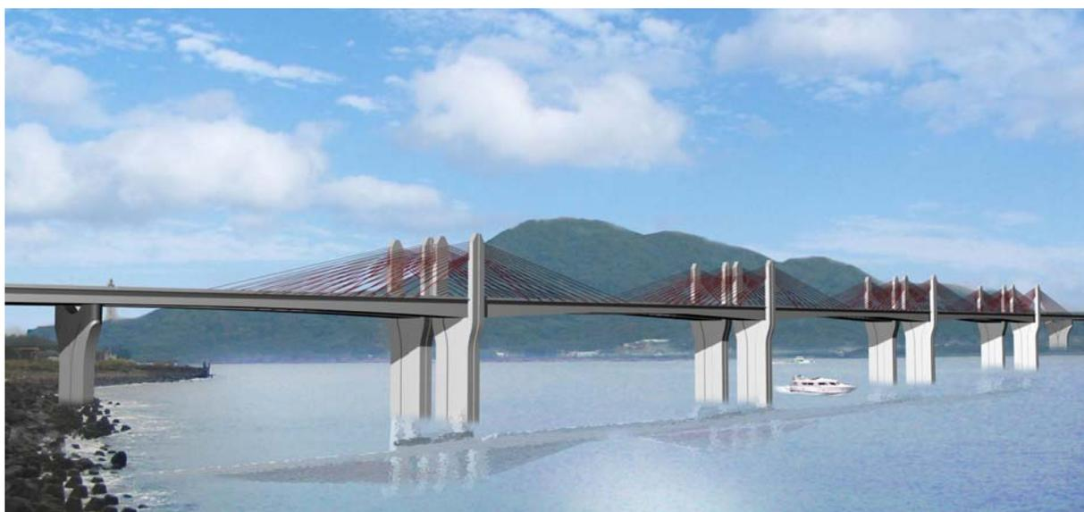
圖 5. 4-3 方案三：斜索外置預力混凝土橋示意圖
