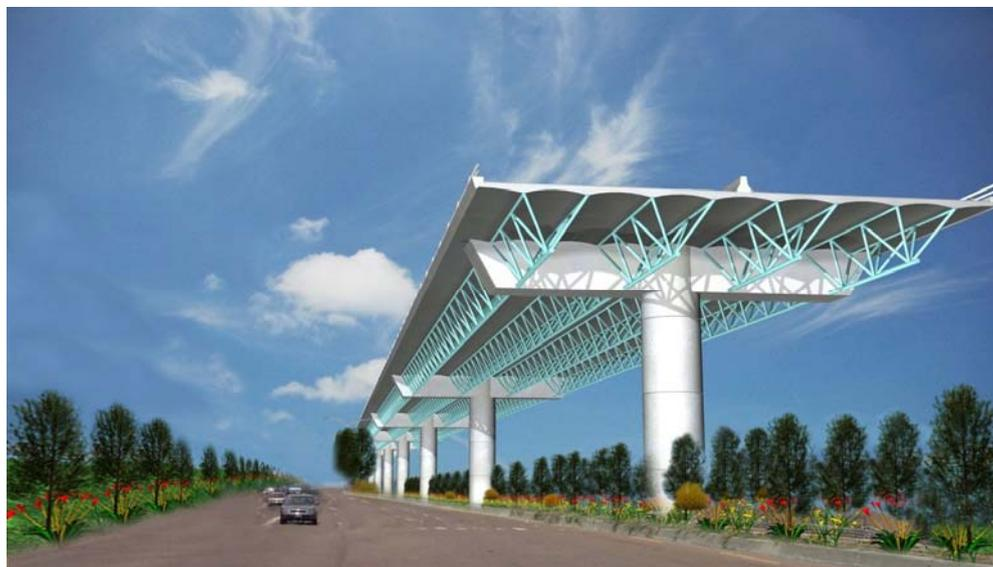
圖 5.5-6 方案 F：鋼管桁架合成梁橋示意圖
