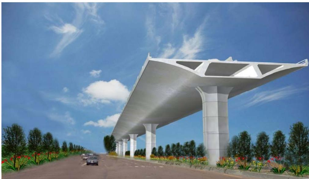
圖 5. 5-3 方案 C：弧型翼板預力箱型梁橋示意圖
