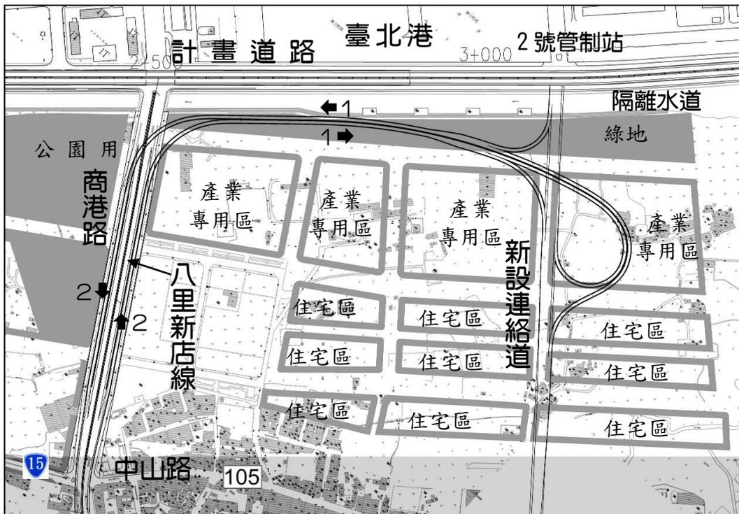
圖 4.2.1-3 與八里新店線銜接方案二(新設連絡道)示意圖
