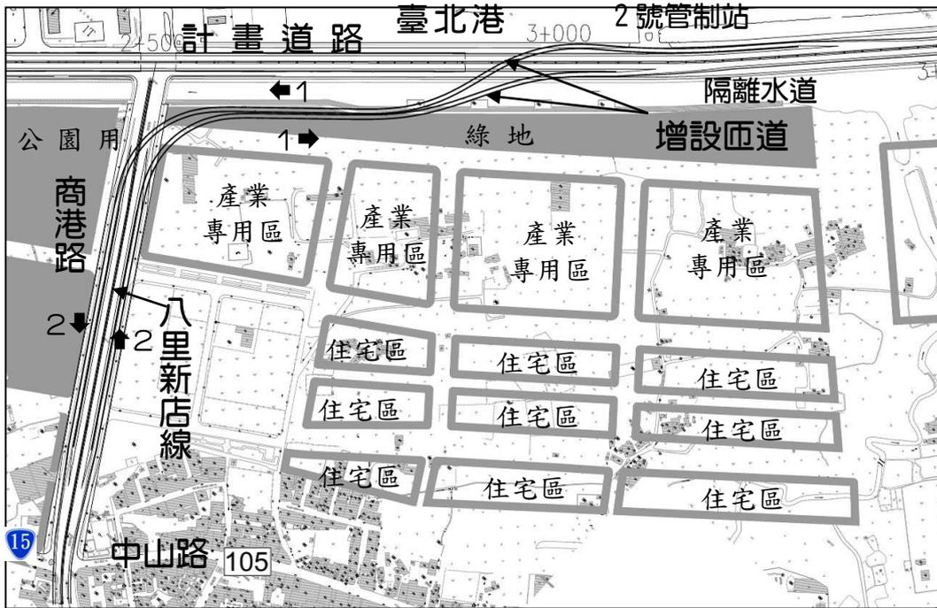
圖 4.2.1-2 與八里新店線銜接方案一(設直接式匝道)示意圖
