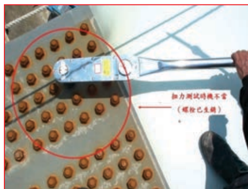
圖 3-32 螺栓已生銹影響 K 值
