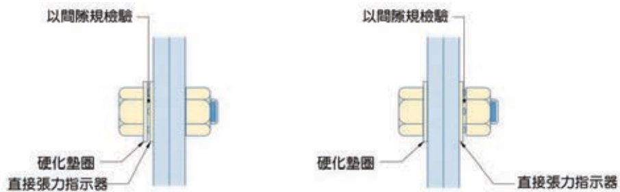
(c) 直接張力指示器位於螺栓頭 (d) 直接張力指示器位於螺帽 並轉動螺栓頭鎖緊時並轉動螺栓頭鎖緊時
