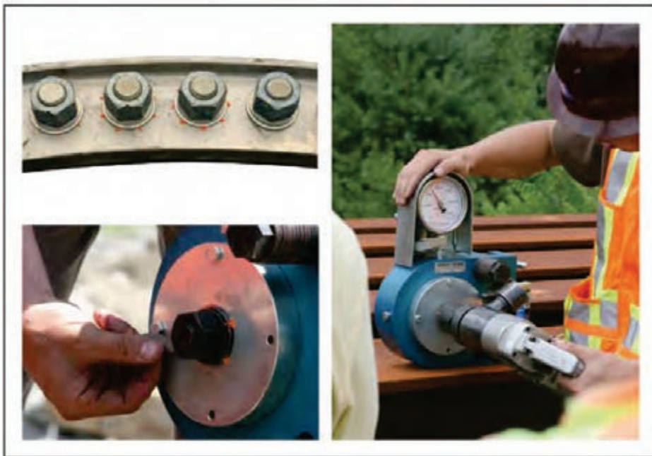
圖 3-13 直接張力指示器法測試與驗證
