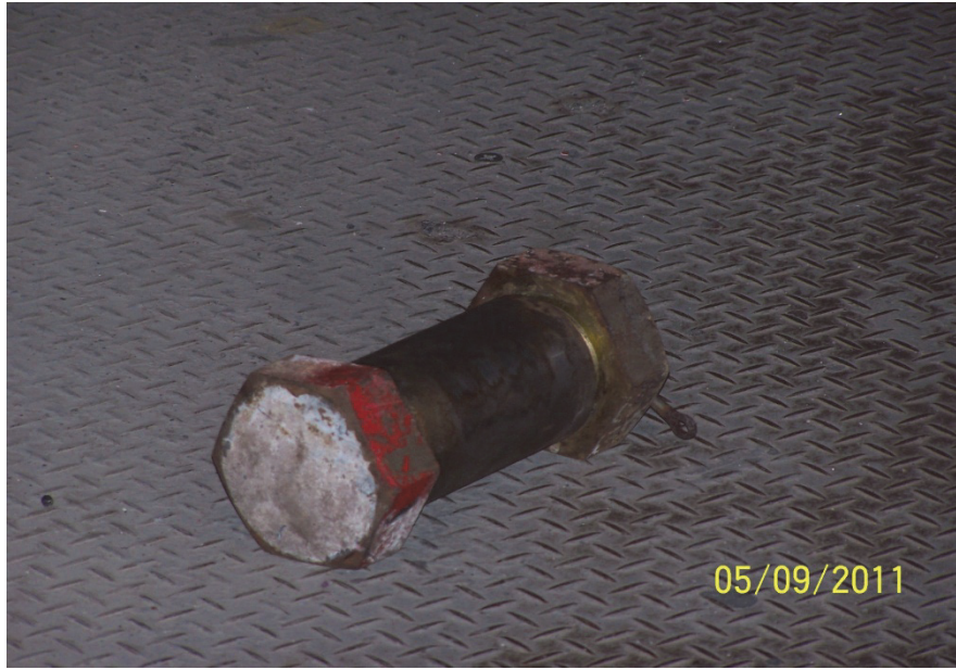
照片 19 拆卸下來的舊連結插銷
