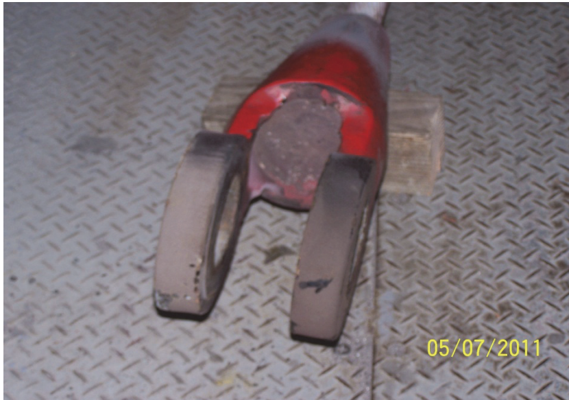
照片 18 狀況良好的舊吊耳
