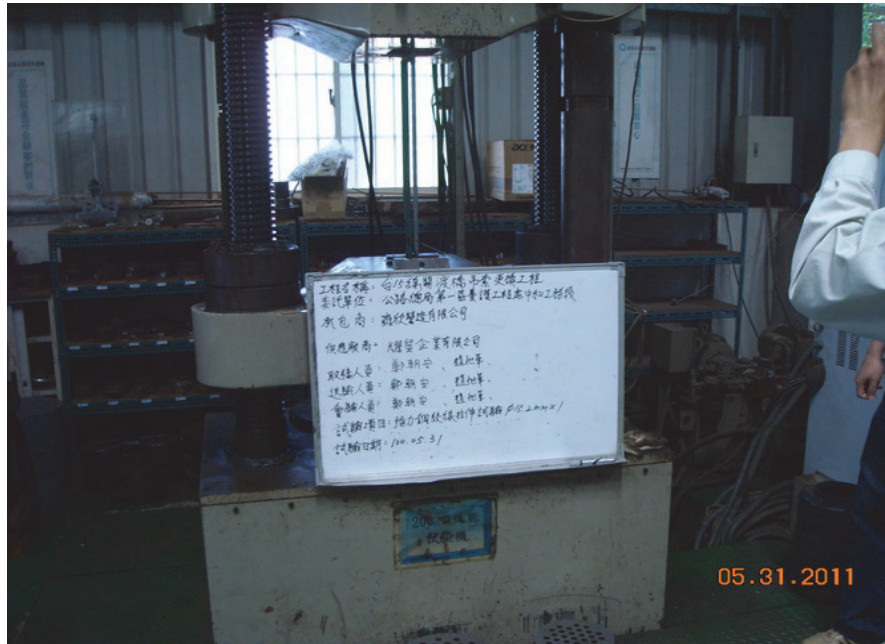
照片 40 吊索單根試拉會同試驗
