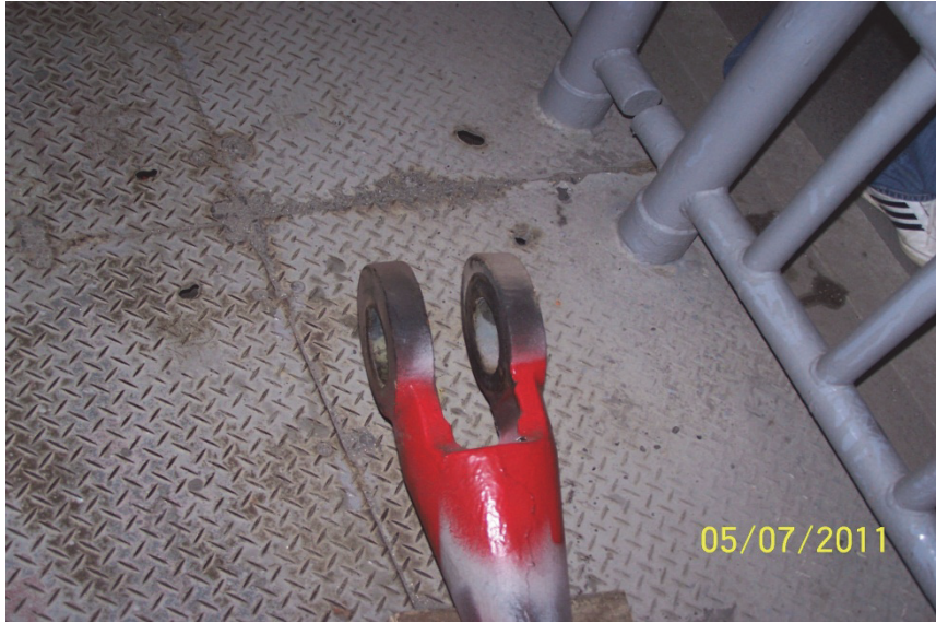
照片 17 拆卸下的吊耳
