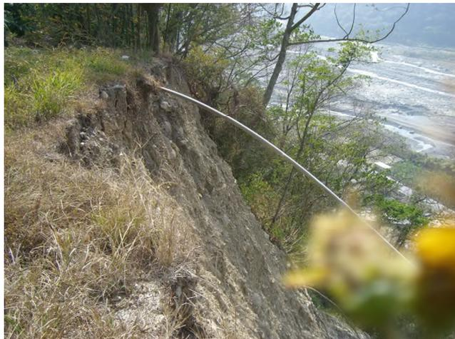
圖 2-2 坡頂於滑動破壞後尚存之張力裂縫
