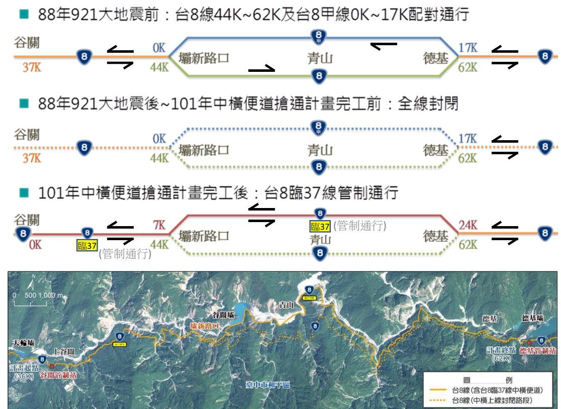
圖 2 中橫公路上谷關至德基路段上線(台8)、下線(台8甲)及便道里程圖
