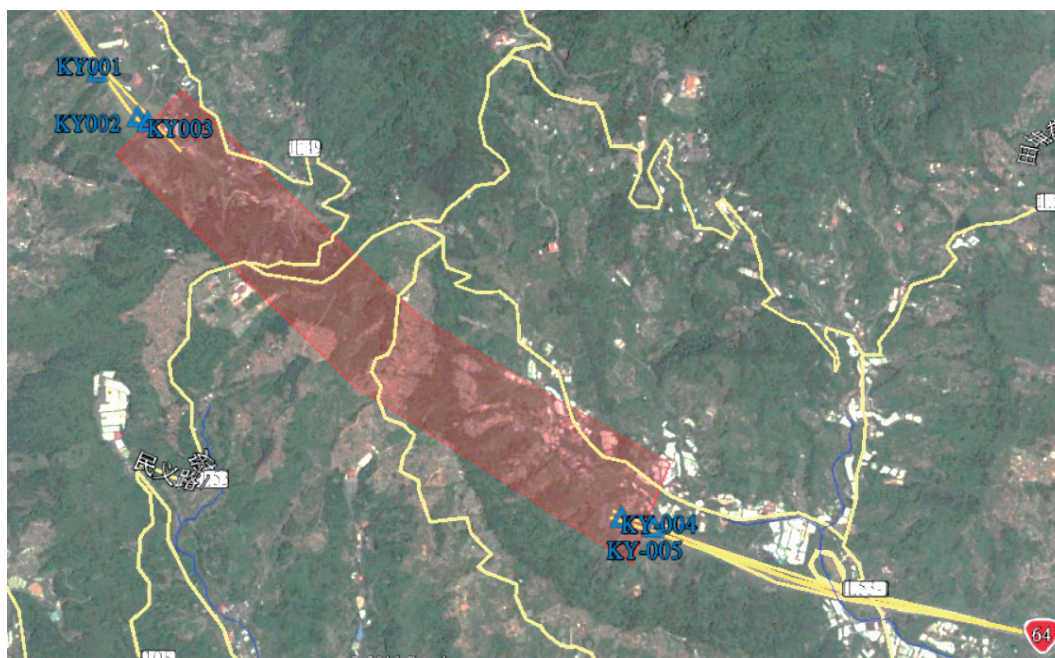
圖 4-2 新設加密控制點位分布圖
