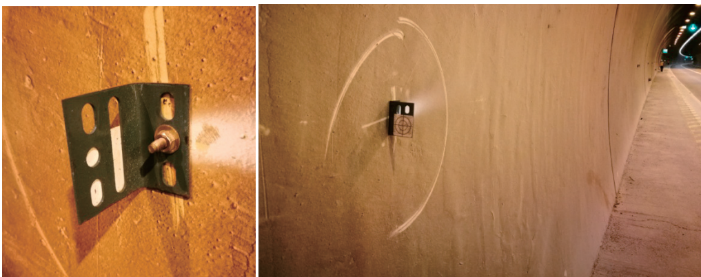
圖 4-5 反射稜鏡標之佈設照片
