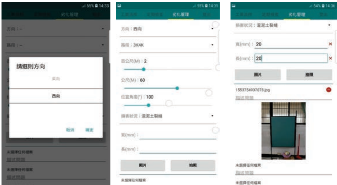
圖 6-16 手機裂縫照片現場處理
