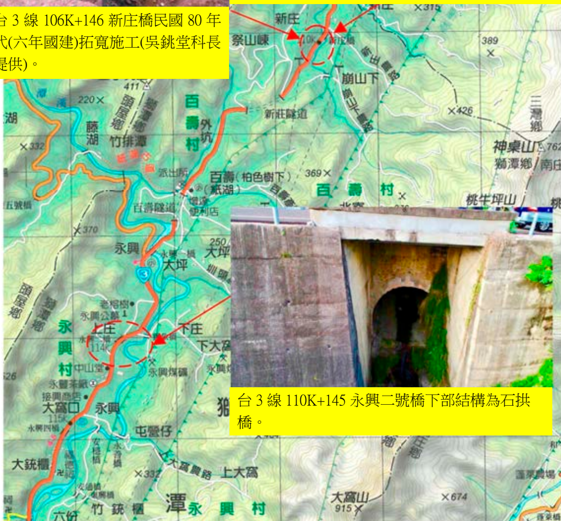
圖 4-1 台 3 線新庄橋及永興二號橋為與石造拱橋結構。
