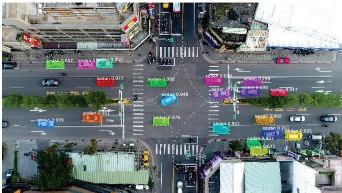
圖 8 利用 Mask R-CNN 進行車輛偵測與分類結果圖
