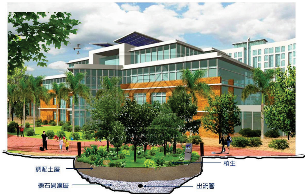
圖 2.2 植生滯留槽（雨花園）剖面構造示意圖
