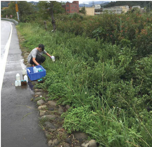
圖 4.1 雨花園入流水水質採樣 4.2 雨花園出流水水質採樣
