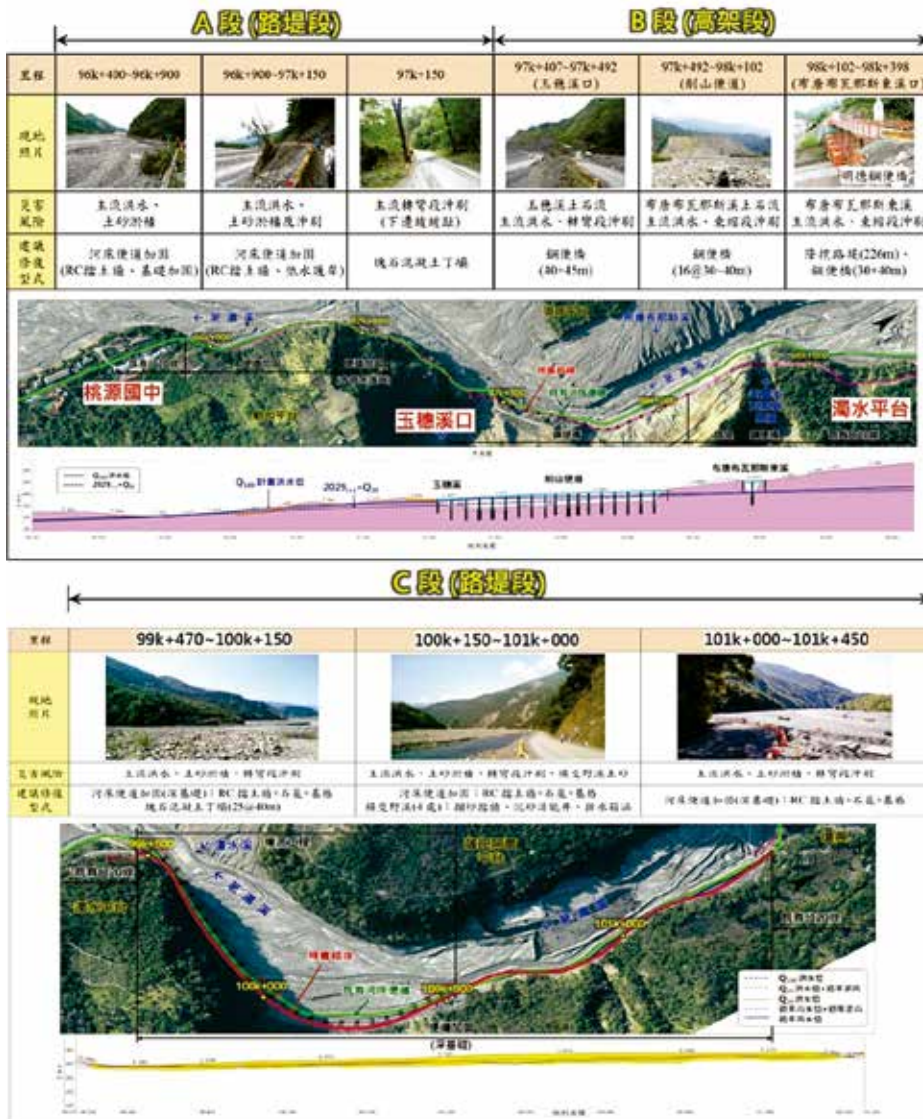
圖 7 台 20 線勤和~復興中期道路分段原則（路堤及高架）
