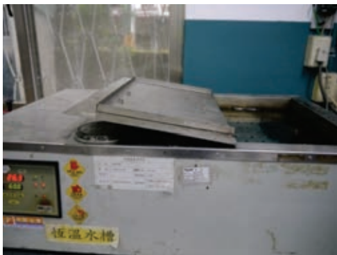
1. 將試體放入 60^\circ\text{C} 水槽 30min
