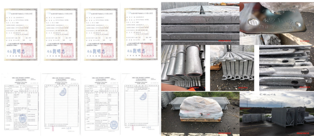
圖 5-6 施工架相關檢試驗證明文件及進場照片
