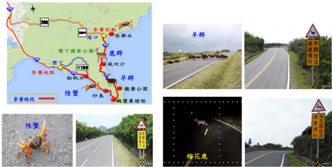
圖 20 增設當心動物標誌改善情形
