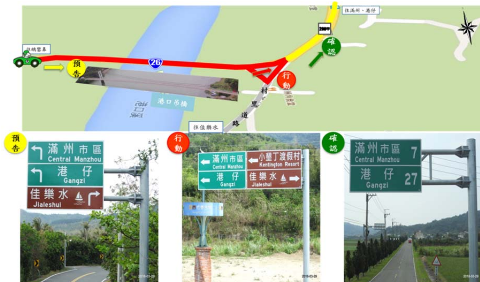
圖 6 台 26 線 54k+258 港口叉路口接縣道 200 甲線南下往港仔方向指示牌面資訊
