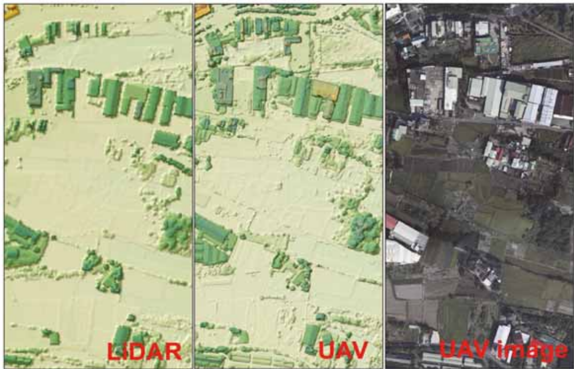
圖 2.7 LiDAR DSM vs. UAV DSM 之空間解析度比較情形及 UAV 正射影像
