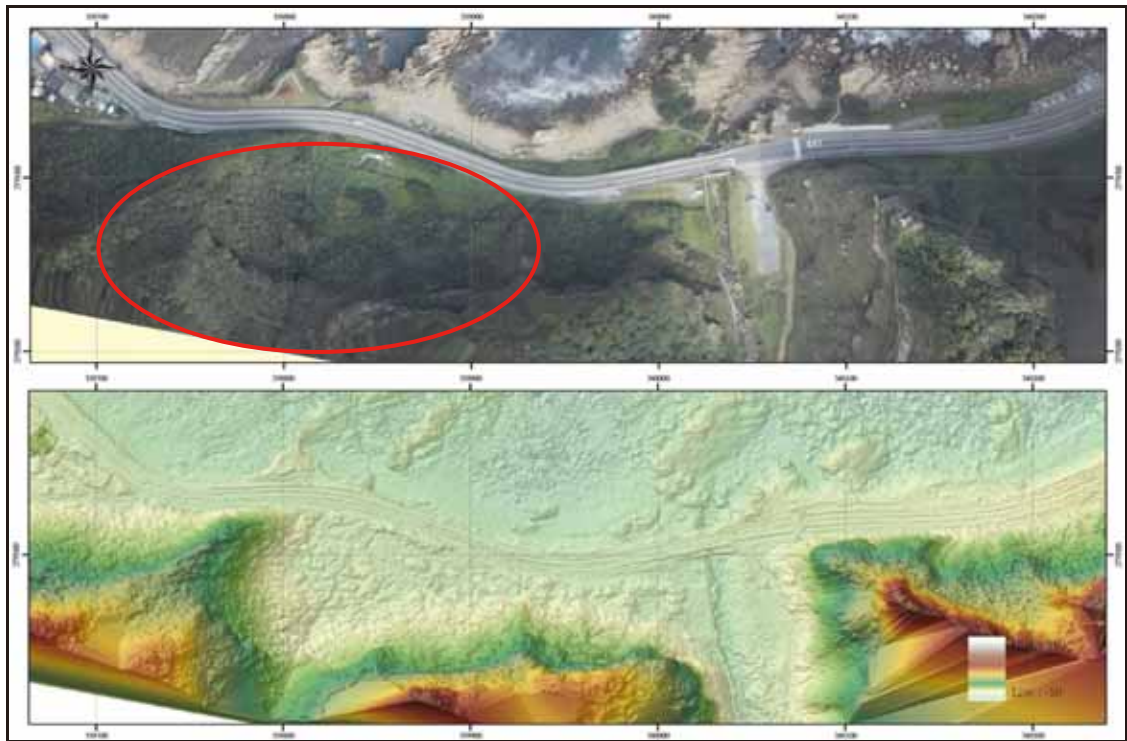
圖 2.30 82k 附近崖頂岩體崩落情形
