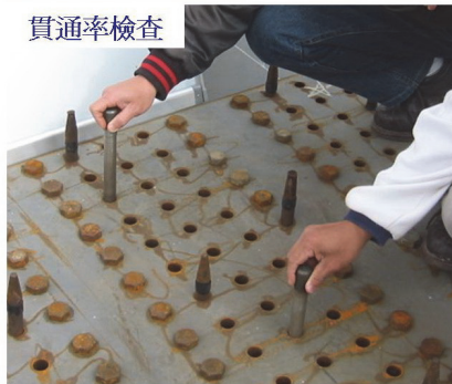
照片 31 螺栓孔貫通率及阻塞率檢查
