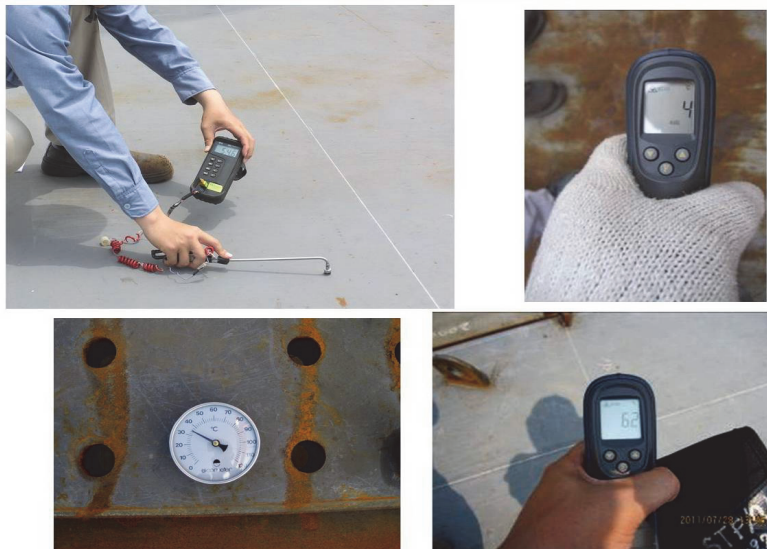
照片 35 預裝構件溫度量測
