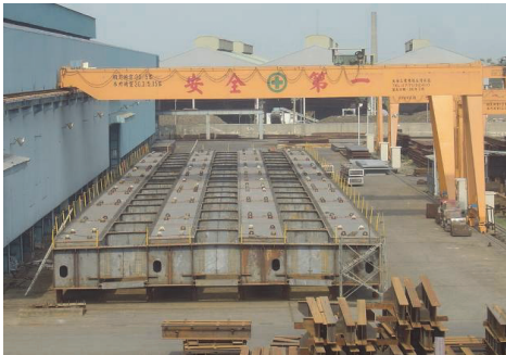
照片 1 鋼橋 (宜鋼鋼構)
