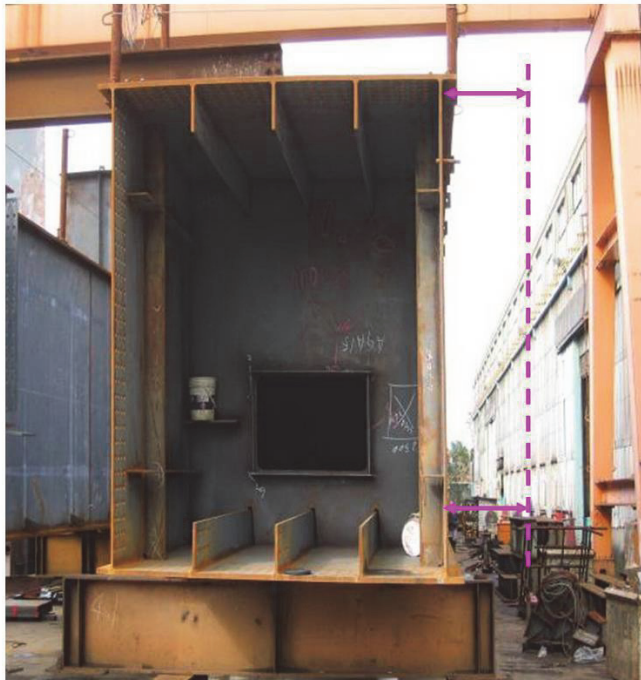
照片 43 主梁腹板正直度檢測(使用經緯儀-春源鋼構)
