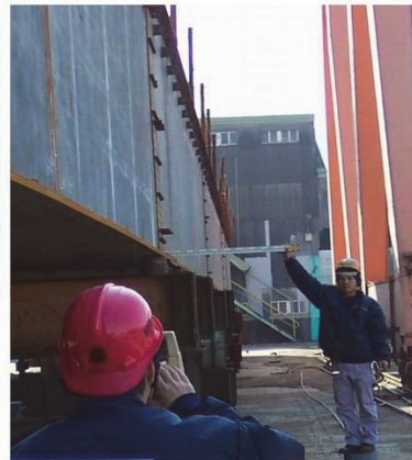
照片 43 主梁腹板正直度檢測(使用經緯儀-春源鋼構)
