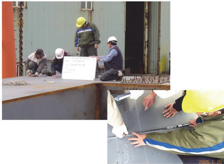
照片 33 預裝構件以鋼尺配合拉力磅秤量測
