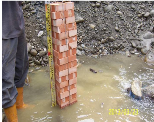
照片 3-4 P7-P8 橋墩中央處開挖坑洞吊放沖刷磚情形
