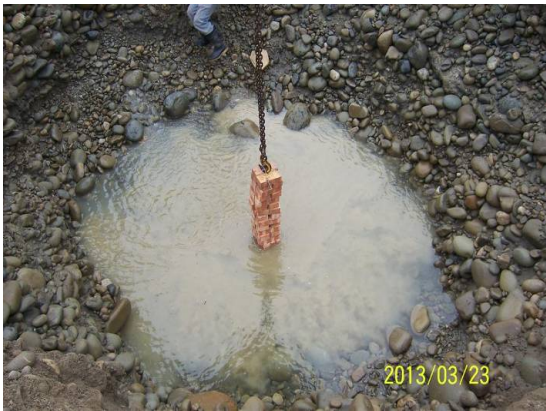
照片 3-4 P7-P8 橋墩中央處開挖坑洞吊放沖刷磚情形
