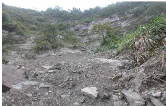
圖 14 巔頭明隧道上方脆性破裂的剪裂帶岩石
