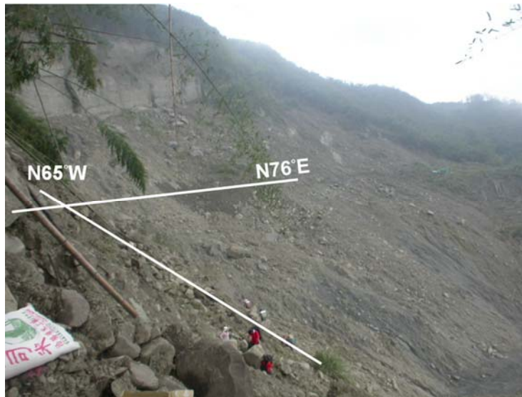
圖 22 地滑區走向為 N65^{\circ}W 及 N76^{\circ}E 之剪裂帶
