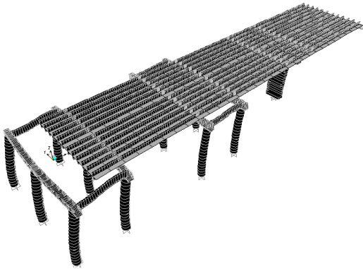
圖 26 P9、P10 頂升完成後橋梁模態(一)
