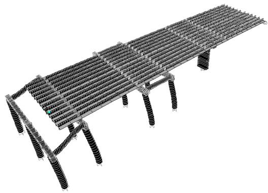
圖 27 P9、P10 頂升完成後橋梁模態(二)
