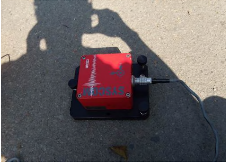
微震量測實驗-微震測量儀
