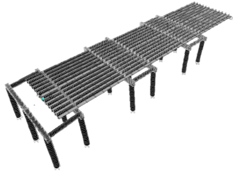
圖 31 P9、P10、P11 頂升完成後橋梁模態(二)
