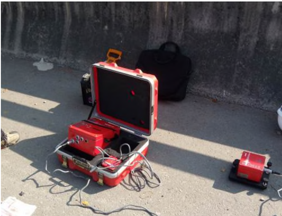
微震量測實驗-收集記錄器
