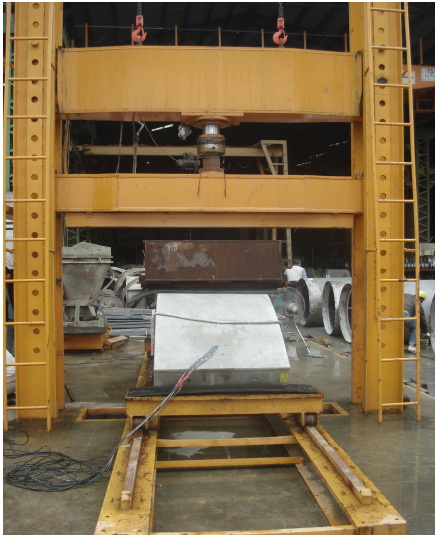
圖十一 RC 環片雙點反覆載荷試驗
