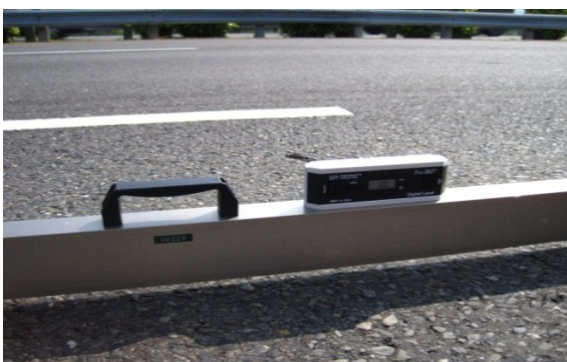
圖 3.3.4 縱、橫向坡度量測試驗(99/10/14)
