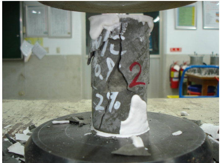
圖 6 抗壓強度試驗照片
