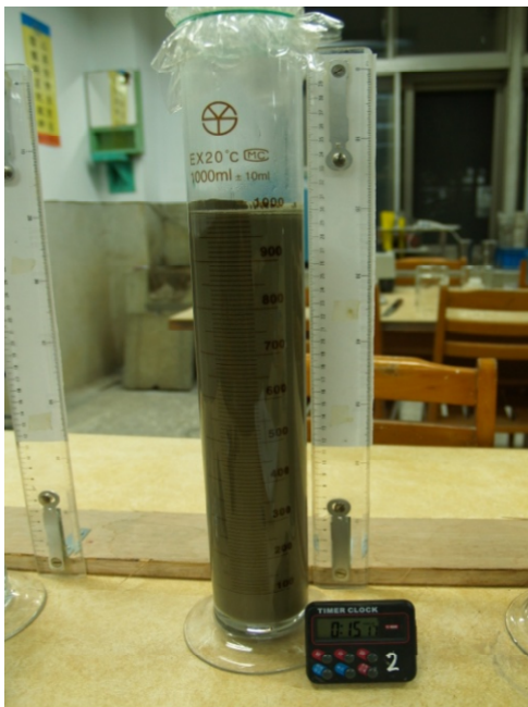
圖 3 泌水試驗照片
