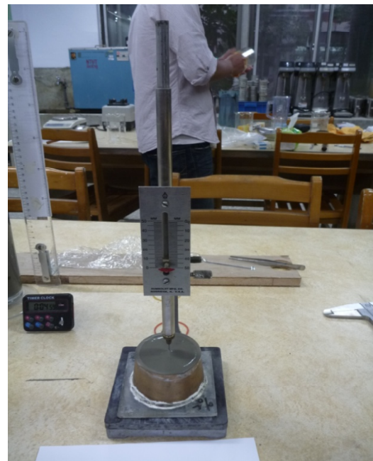
圖 4 凝結時間試驗照片
