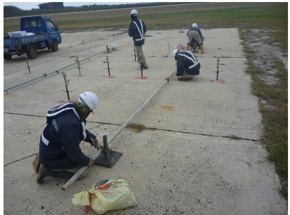
圖 26 監測點測微錶佈設
