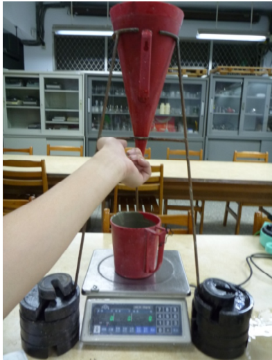
圖 5 馬氏漏斗儀試驗照片
