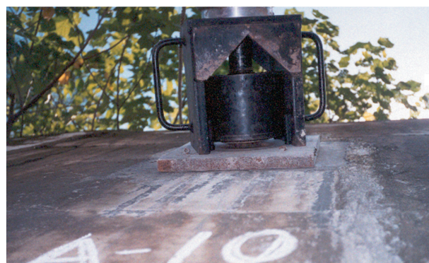
照片-4 A-10 地錨試驗情形
