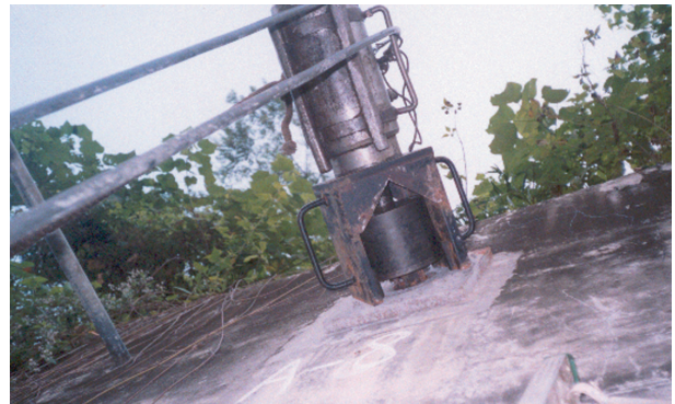
照片-12 A-8 地錨試驗情形
