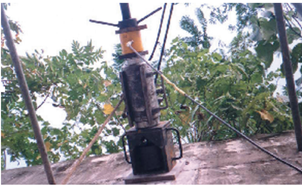
照片-13 A-10 地錨試驗情形
