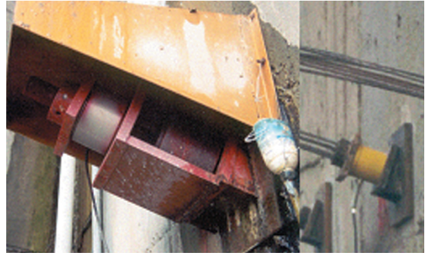
揚起試驗後安裝之地錨荷重計 地錨施做時即安裝之地錨荷重計
