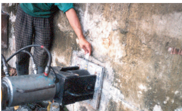
照片-7 C-60 地錨試驗情形
