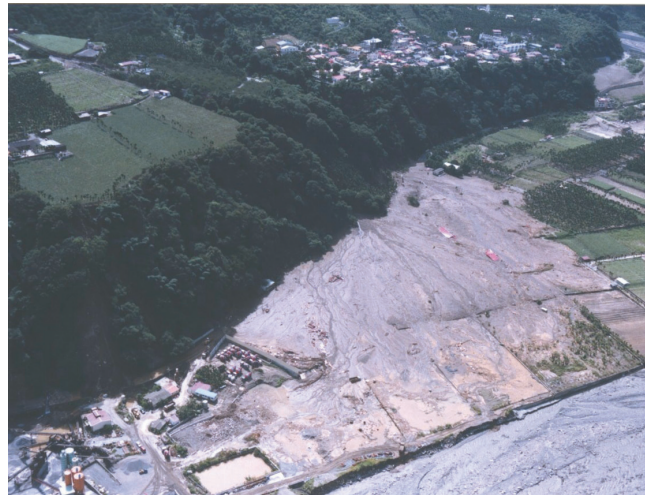
圖111 台21線96K+000~96K+800 路基遭土石流淹沒(空照)
