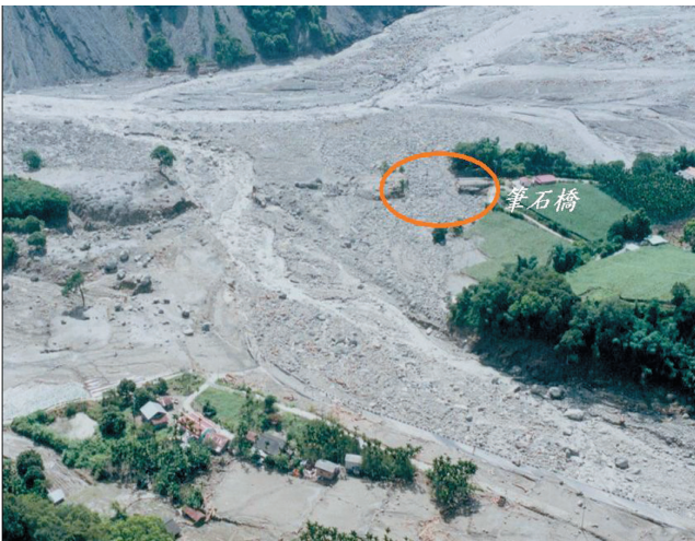
圖29 筆石溪匯流處的沖積扇（筆石巷）及台21線筆石橋受損情形（空照）
