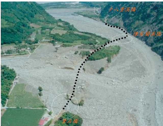
圖27 桃芝颱風後，被沖失之陳有蘭溪橋、筆石橋及其間路基覆蓋土石（空照）
