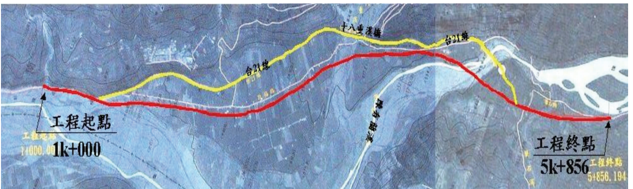
圖35 十八重溪橋~筆石橋改線初步規劃示意圖
