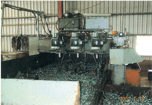
接合板NC鑽孔
