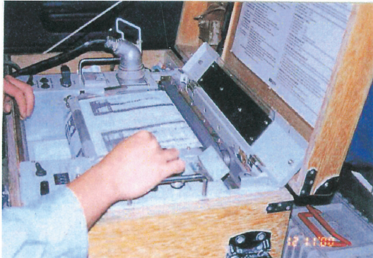
基樁深度及垂直度檢查
